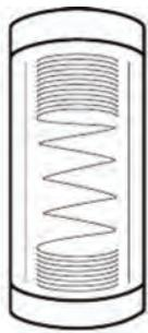
Uvek kada solarni kolektor primi sunčev zrak i pretvori ga u toplotu, solarni bojler preuzima tu toplotu i skladišti je. Bojleri su veoma važni delovi solarnih sistema jer čuvaju akumuliranu toplotu koliko je potrebnou.
