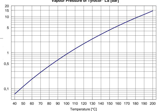
Vapour Pressure of Tyfocor<sup>®</sup> LS [bar]
